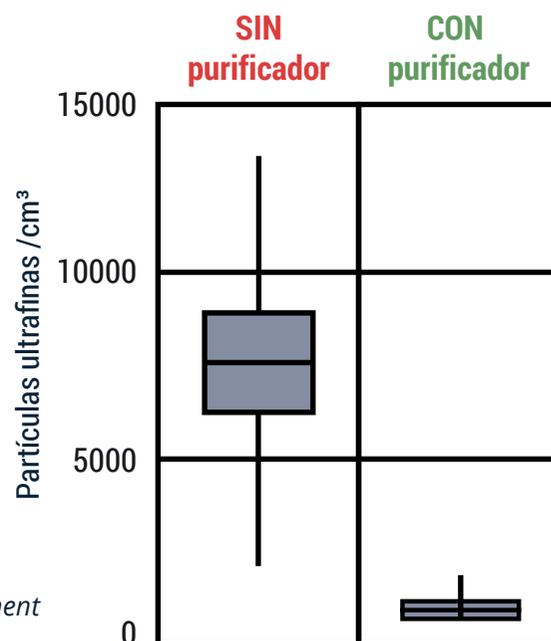
En el ejemplo, hay dos purificadores de aire, con un caudal de 1200 m<sup>3</sup>/h cada uno en un gimnasio escolar de 270 m<sup>3</sup> (100 m<sup>2</sup> \* 2.7 m).
